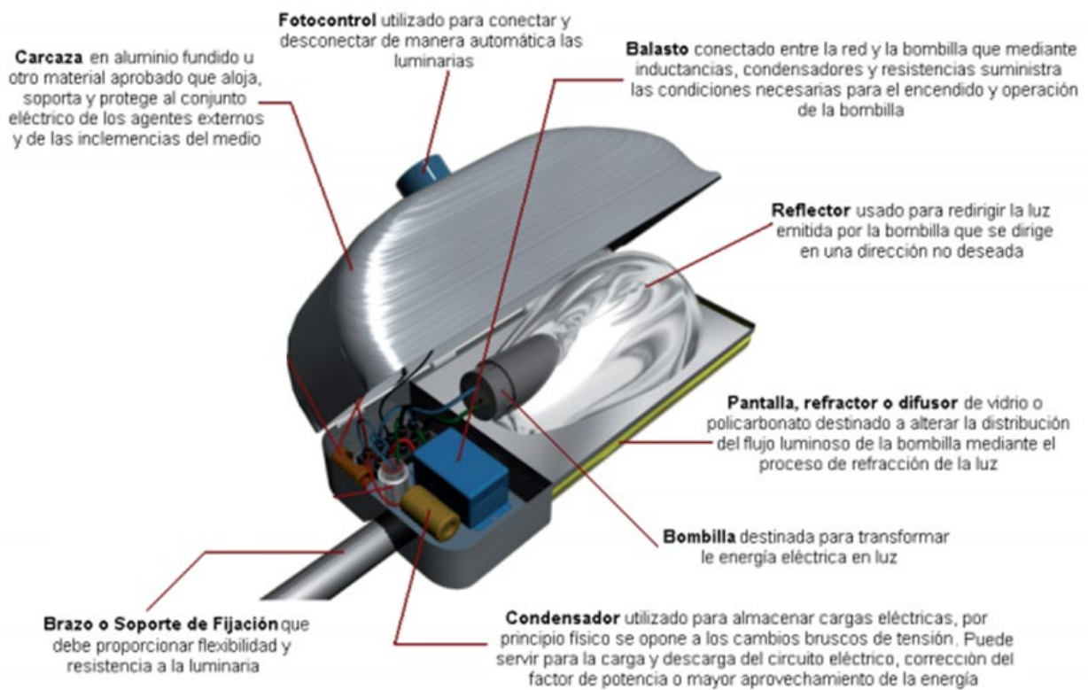
Figura 20: Composición de la luminaria
